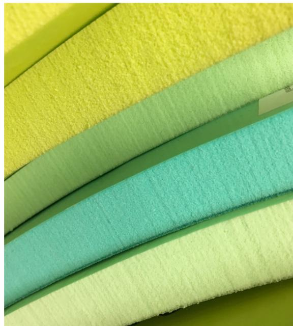
*Hartschäume aus expandiertem Polystyrol (EPS) für die Gebäudedämmung.*
